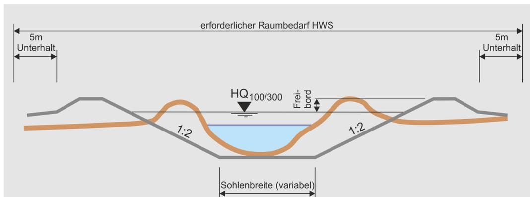
**Abbildung 5:** Querprofilbetrachtung für Fließgewässer mit Damm
